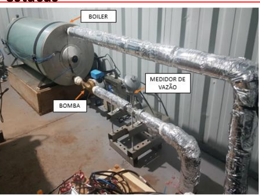
Figura 2 – Ensaio TRT em fundações metálicas (diam. de 32 cm e profundidade de 20 m)
