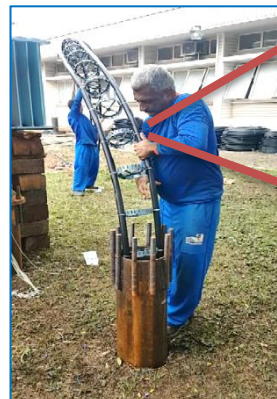
Figura 2 – Ensaio TRT em fundações metálicas (diam. de 32 cm e profundidade de 20 m)
